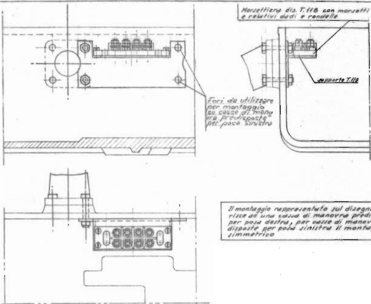
Applicazione della morsettiera ausiliaria per l'ancoraggio dei conduttori relativi all'elettromagnete di intallabilità
