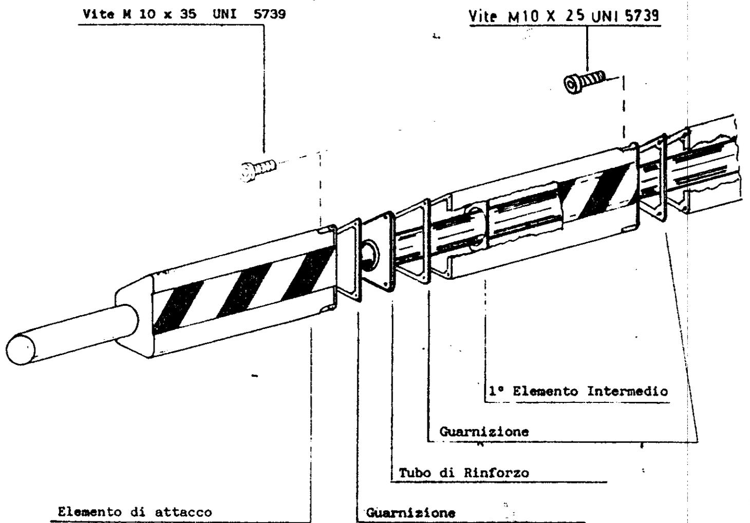
SCHEMA DI MONTAGGIO DEL TUBO DI RINFORZO ALLE ASTE MODULARI
