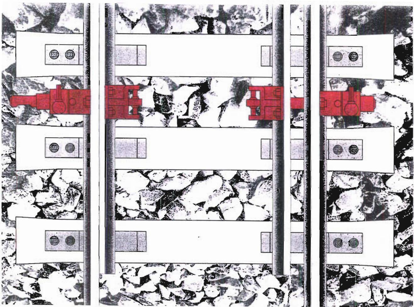
FIG.2: vista complessiva del piano di posa con dispositivo in posizione di deviatore "BLOCCATO"
