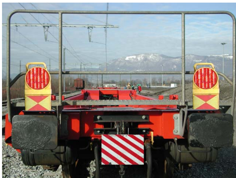
Figura 1 - Segnali di coda dei treni interoperabili
